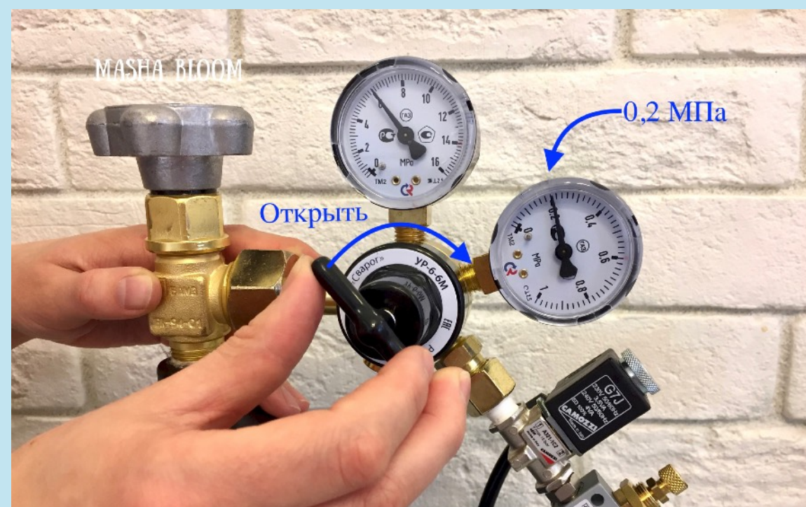
8. Продолжайте ОТКРЫВАТЬ Маховик редуктора по часовой стрелке пока Манометр давления на выходе не покажет 0,2 МПа
